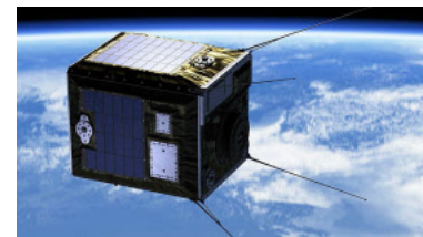
超小型衛星1つにおよそ1000個の「流れ星のもと」を積み込む
